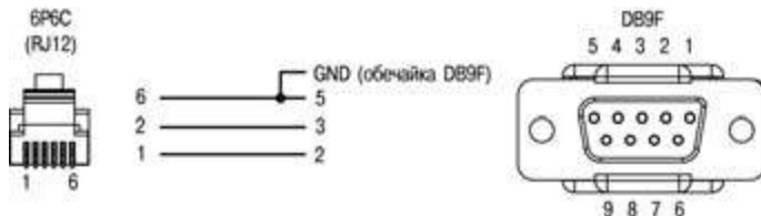
Рисунок Г.3 – Кабель KC2 для подключения ПЛК110 к панелям ИП320, СП270 и СП3хх (порт RS-232 Debug)
