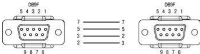
Рисунок Г.6 – Кабель KC4 для подключения ПЛК110 к панелям ИП320, СП270 и СП3хх (порт RS-232 Download)
